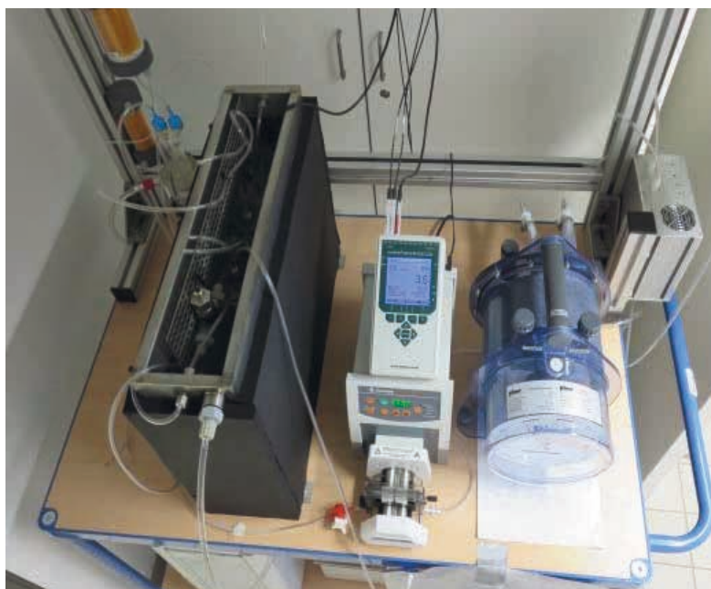
Abbildung 5: Versuchseinrichtung zur Gasreinigung (Ausschnitt) mit Adsorptionskolonnen im Wasserbad (links), Messgaskühler (hinten rechts) und Trocknungskolonnen (hinten links) (© Hochschule Weihenstephan)
