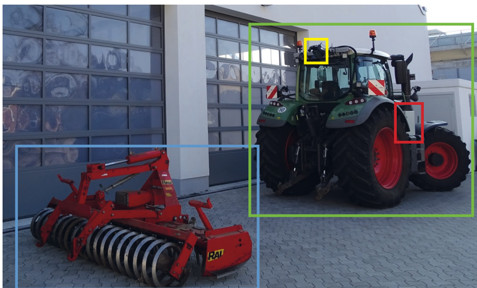
Abbildung 2: Versuchsaufbau für das Ankoppeln an Anbaugeräte (Blau: Anbaugerät, Grün: Versuchsfahrzeug, Gelb: Sensor, Rot: Energieversorgung)
