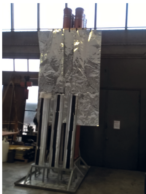
Abbildung 1: Versuchsaufbau zur Untersuchung des Einflusses von Stapelhöhe und Partikelgröße auf die Sickersaftbildung von Silage aus gehäckselten Zuckerrüben (© Universität Hohenheim/S. Zielonka)
