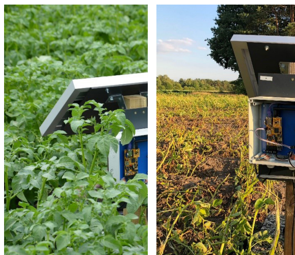
Abbildung 4: Die Abbildungen zeigen die unterschiedliche Umgebungsbedingungen für die Sammelknoten auf dem Feld. Im ersten Bild wird der Knoten fast von dem Kartoffelkraut umschlossen, auf dem zweiten steht der Knoten frei im Feld.
